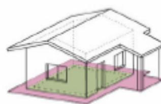
2- Emprise au sol «recours à l'architecte» : elle correspond à la projection verticale du volume de la partie de la construction constitutive de surface de plancher (exemple : les auvents, ou les surfaces aménagées pour le stationnement des véhicules ne sont pas prises en compte).
