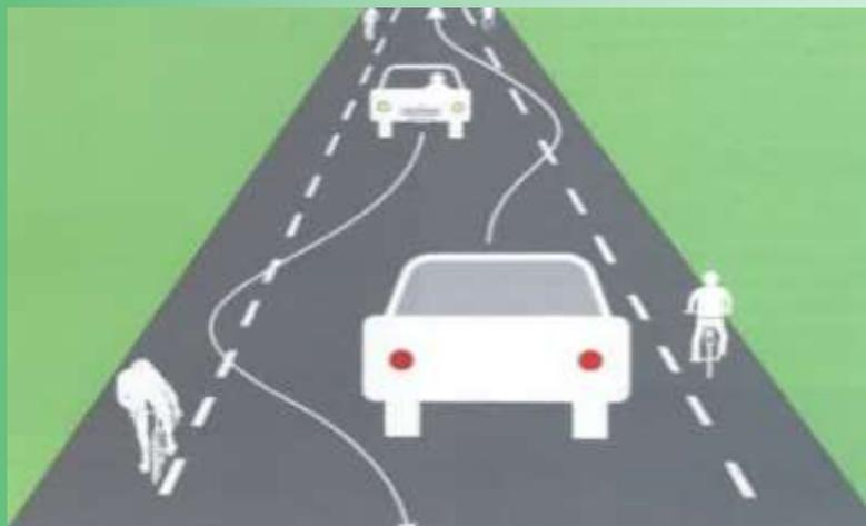
La CVCB est une chaussée sans marquage axial dont les lignes de rive sont rapprochées de son axe. Les véhicules motorisés circulent sur une voie centrale et les cyclistes sur les accotements.
