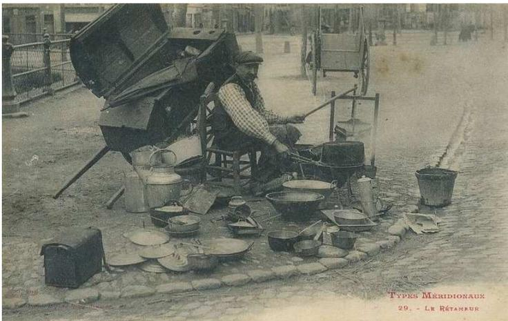
Il commençait par décaper les ustensiles au moyen d'un mélange corrosif d'esprit de sel (acide chlorhydrique), de cendre et de sable fin. Il les trempait ensuite dans de l'acide additionné de zinc. Puis, il faisait chauffer un bain d'étain dans lequel il plongeait rapidement chaque objet.
