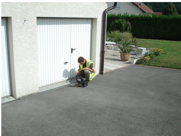
Pose de sismographes sur les fondations des habitations de Marchaux
